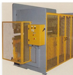
Sistema de protecciones mecánicas con finales de carrera de seguridad y módulos cat. IV.
